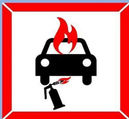
ПОДОГРЕВ ДВИГАТЕЛЯ ОТКРЫТЫМ ОГНЁМ
