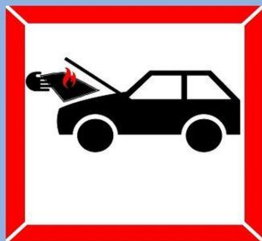
УТЕПЛЕНИЕ ДВИГАТЕЛЯ ГОРЮЧИМИ МАТЕРИАЛАМИ
